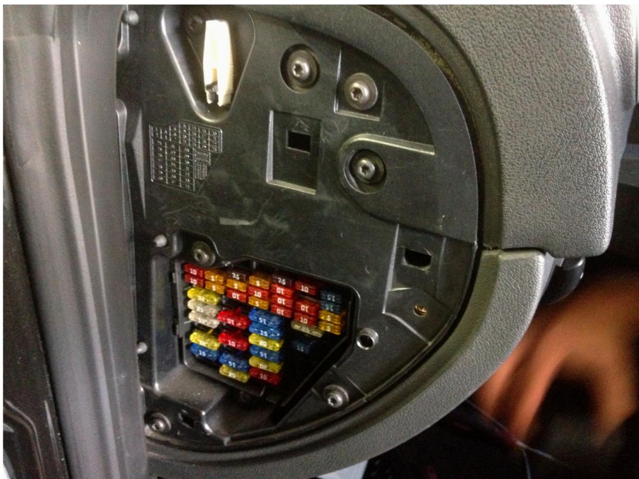
Le démontage de tout le bloc est également possible en retirant les vis situées aux angles
